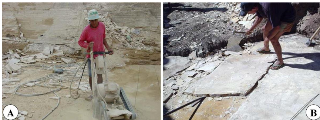
Figura 6: A , Método de lavra semi-mecanizado, com o uso de serra de piso. B , método de lavra rudimentar. Fonte: Vidal et. al. (2005).
